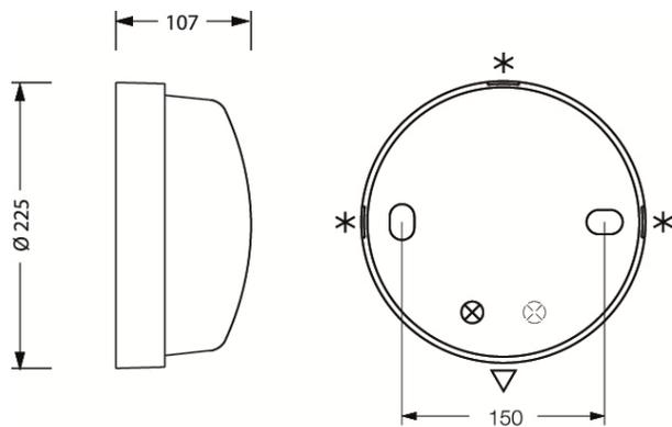
\* Pré-découpes entrées latérales tube  $\varnothing$  16 mm ou  $\varnothing$  20 mm / moulure
